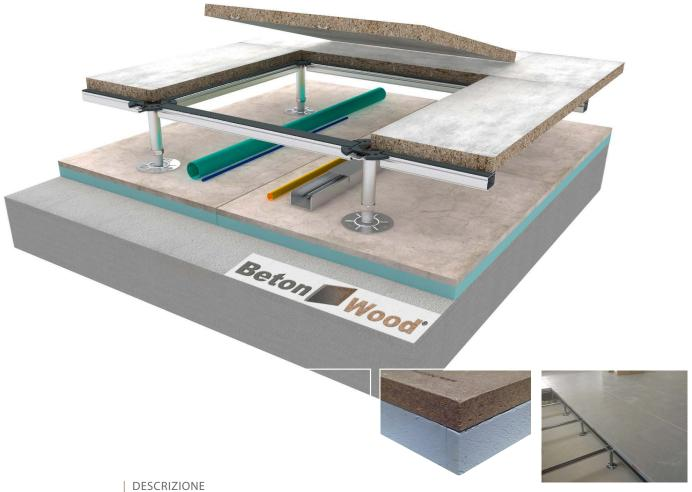
Sistema completo a secco per pavimenti sopraelevati su pannelli accoppiati ad elevata resistenza a compressione ed elevato isolamento termo-acustico in cementolegno e polistirene estruso Betonstyr.
